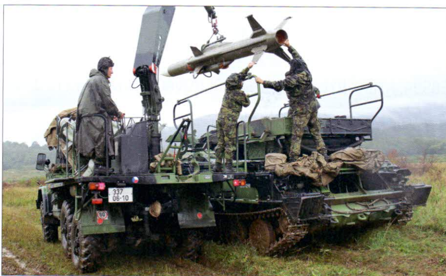
Přesun řízené střely 3M9M3 z nabíjecího přepravníku na odpalovací zařízení systému 2K12 KUB
