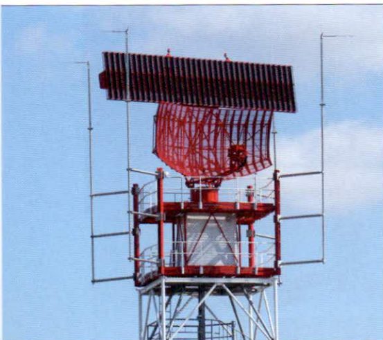
Novými senzory v systému protivzdušné obrany jsou také letištní radiolokátory RPL-2000
